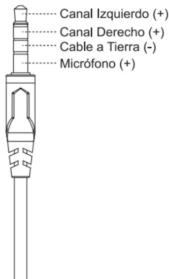
**Fig. 3 | Usos del Conector**
