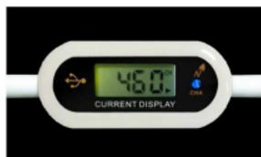
Si el voltaje y amperaje del cargador es 5(V)2(A) y el display muestra mas de 1200mAh, como la siguiente imagen quiere decir que la capacidad de corriente de la fuente de alimentación de salida es real
