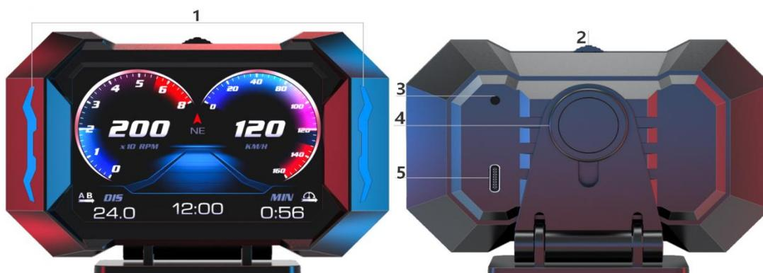
1. Luz ambiental: varía según la velocidad del motor o la velocidad del vehículo.
