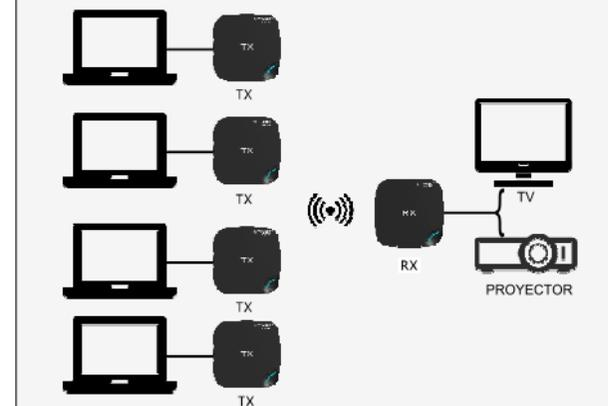
1. El botón lateral del transmisor (TX) sirve para vincularse al receptor, y el botón del receptor (RX) sirve para reset (Presionar por 2-3 segundos para lograrlo)
