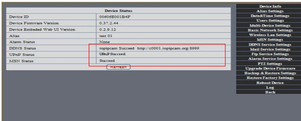
·Necesita configurar la función de mapeo de puertos correctamente, para revisar si la función UPNP del router está habilitada, si esta deshabilitada, utilice el manual del usuario del router para habilitarla.!
