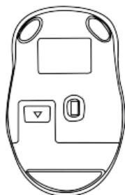
2. Coloque la pila AA en el compartimiento asegurándose que el + y – de la pila coincida con los signos en el mouse. Luego retire el receptor NANO USB y cierre la tapa del compartimiento.
