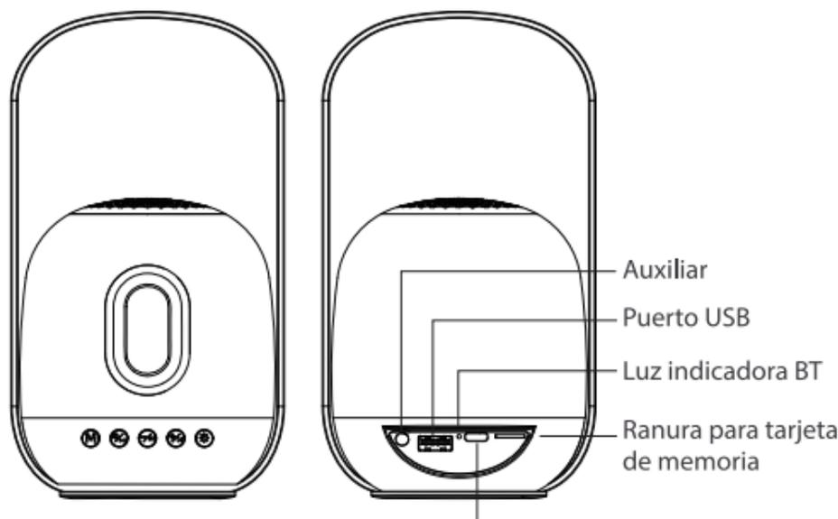
Puerto de carga USB C. Se carga vía USB C con fuente de 5V 1A (no incluida). La luz se encenderá en rojo mientras se este cargando el parlante
