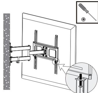
Fije los soportes del monitor a la placa de montaje del televisor apretando los tornillos situados en la parte inferior de los soportes del televisor.
