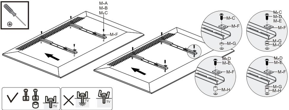
Elija el tamaño del tornillo que coincida con los orificios de montaje roscado ubicados en la parte posterior del televisor. Fije cada soporte a la parte posterior de su monitor usando los tornillos y arandelas de tamaño correcto. Si la televisión requiere el uso de espaciadores, úselos debajo de los soportes, como se muestra.
