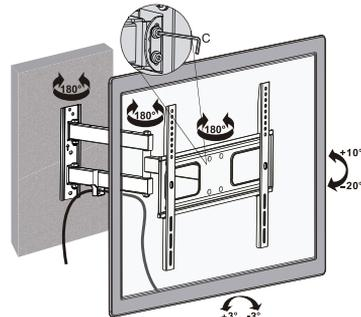
Utilice la llave hexagonal (Allen) para ajustar la inclinación, el giro y la rotación apretando o aflojando los tornillos en el lado de la placa VESA. .
