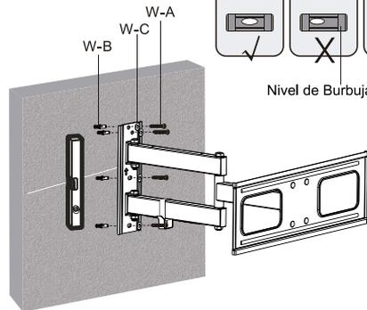
Presente el soporte sobre la pared, marque con un lápiz o fibra los orificios como muestra la imagen, asegúrese que estén bien centrados. Luego perforo los tres (3) agujeros directamente sobre el ladrillo, bloque o concreto donde se hicieron las marcas. Inserte tres (3) tarugos (W-B) directamente en cada agujero taladrado, luego coloque el soporte alineando sus agujeros a los tarugos y atornille los a la pared usando tres (3) tornillos W-A y tres (3) arandelas W-C.
