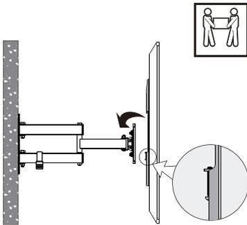
Enganche los rieles del televisor sobre la parte superior de la placa de montaje del televisor.
