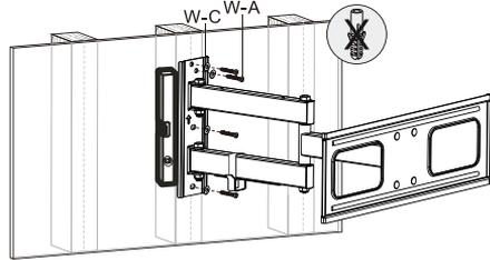
Presente el soporte sobre la pared de madera, marque con un lápiz o fibra los orificios como muestra la imagen, asegúrese que estén bien centrados. Luego perforo los tres (3) agujeros directamente sobre la madera, donde se hicieron las marcas., luego coloque el soporte alineando sus agujeros a los de la madera y atornille los tres (3) tornillos W-A y tres (3) arandelas W-C.
