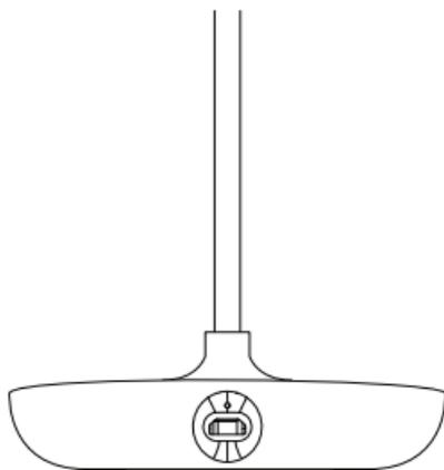
Operación de carga: conecte el USB con el puerto de DC trasero del producto. El indicador rojo se iluminará durante la carga. Se apagará cuando este completamente cargada la batería.
