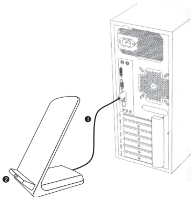
1. Conecte el cable USB al puerto USB de su PC y el extremo Micro USB al cargador inalámbrico.
